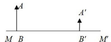
20. На рисунке показаны главная оптическая ось  $MM'$  линзы, предмет  $AB$  и его изображение  $A'B'$ . Определите графически положение оптического центра и фокусов линзы.
